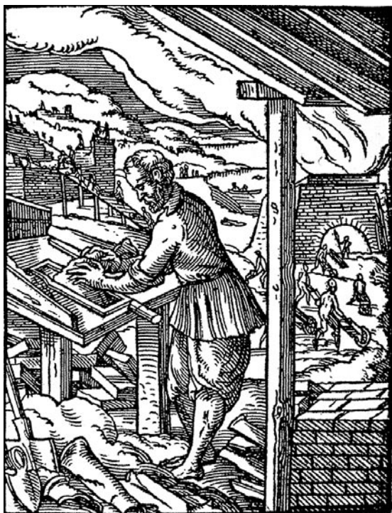
1 pav. Viduramžių plytų gamyba Vokietijoje. Pirmajame plane – plytų gamintojas deda molio mišinį į medinę formą. Amanno Jost'o graviūra iš 1568 m. Hartman'o Schopper'o knygos Panoplia .
