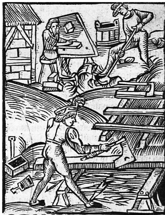
2 pav. Plytų gamyba viduramžiais. Viduryje už stalo sėdi pusgaminių formuotojas, karėje matyti prikrautos pusgaminių pašūrinės džiovyklos kraštas. 1549 m. Medžio raižinys iš Petro Krescentino „Knygų apie ūkininkavimą“.
